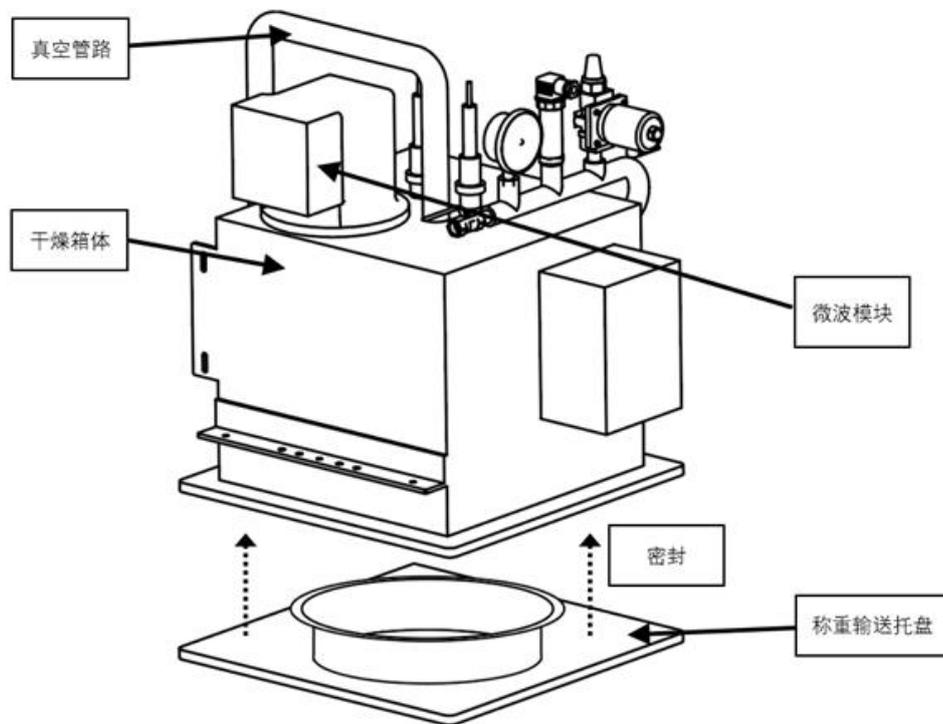
图 B.1 微波真空干燥箱示意图
