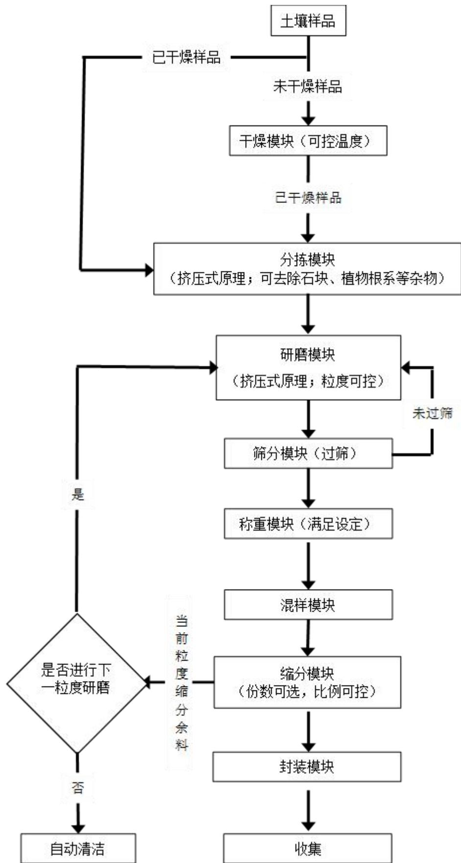
图 2 土壤样品制备自动化流程图
