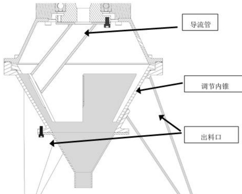
图 B. 12 缩分仪示意
