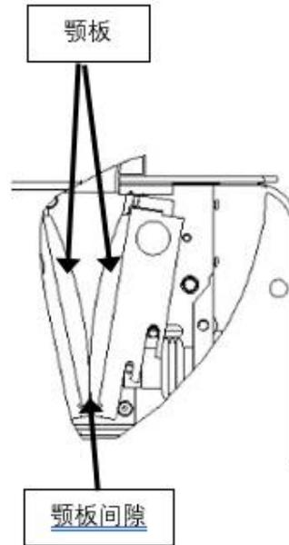
图 B.3 颚式破碎机示意图
