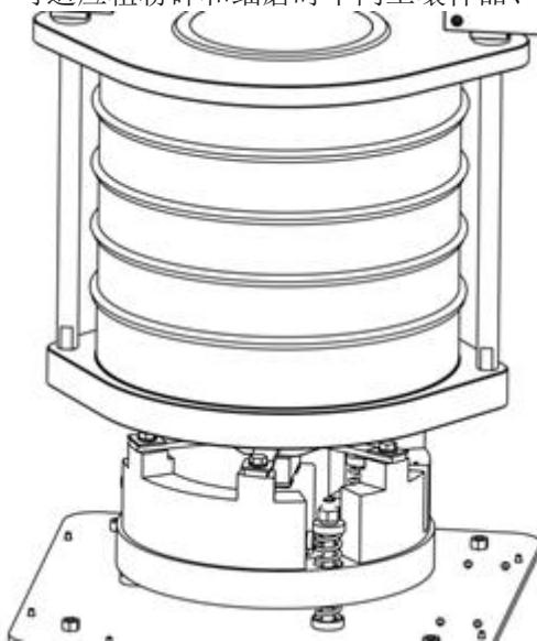
图 B. 8 三维振荡筛分仪示意
