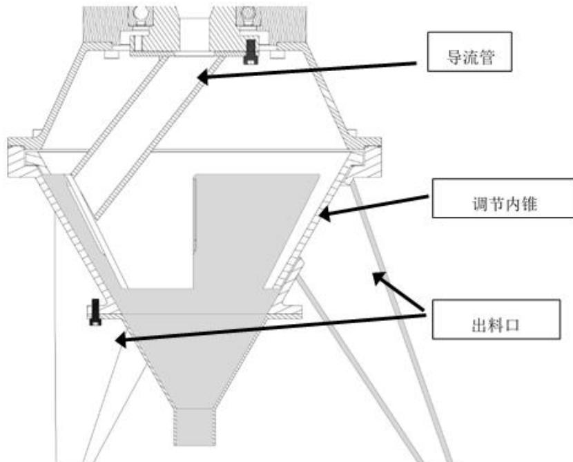
图 B. 12 缩分仪示意
