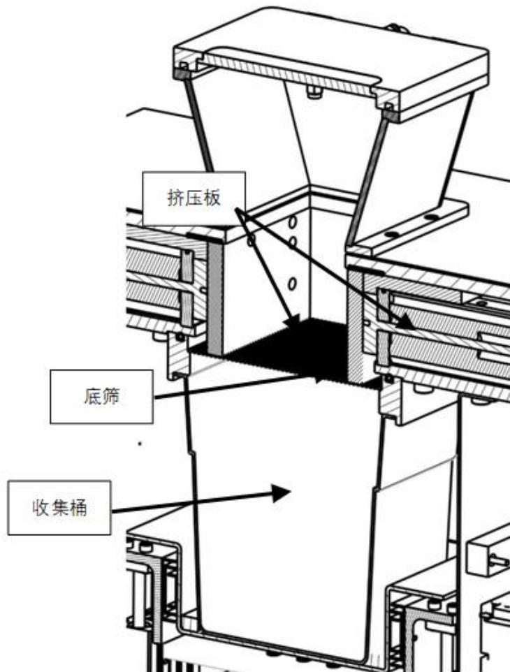
图B.2 挤压式破碎仪示意图
