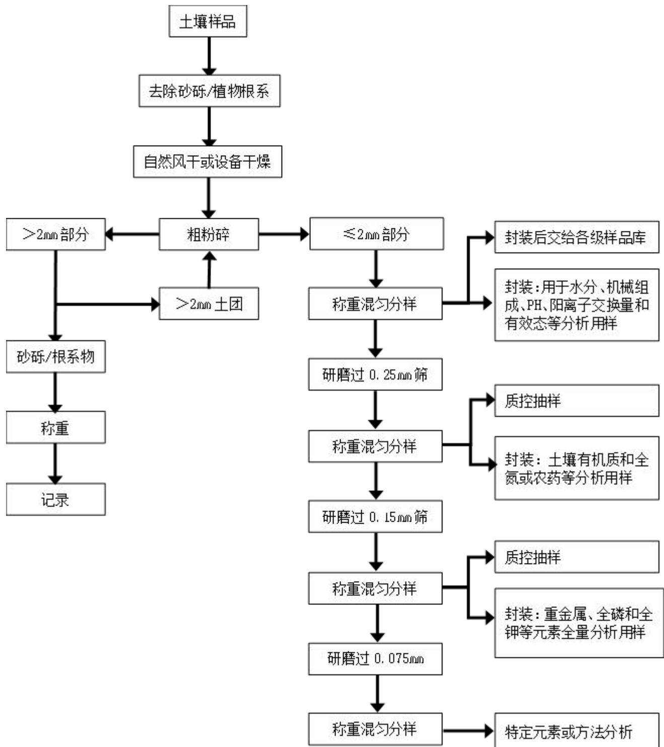
图 1 土壤样品制备半自动化流程图
