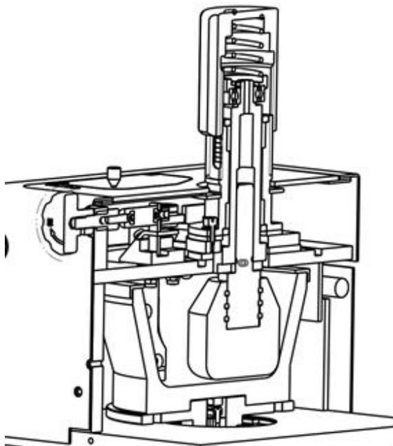
图 B.5 臼式研磨仪示意
