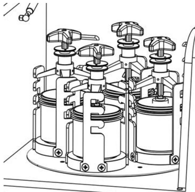
图 B. 4 行星式球磨仪，四罐型示意
