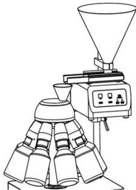
图 B. 11 旋转分样仪示意
