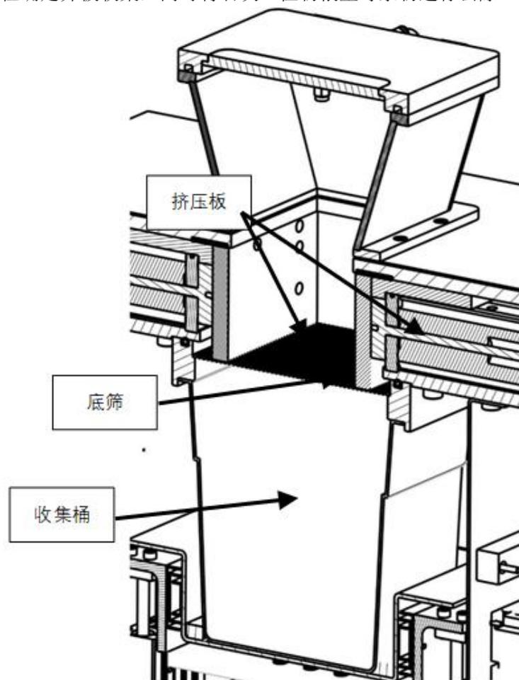
图 B.2 挤压式破碎仪示意图
