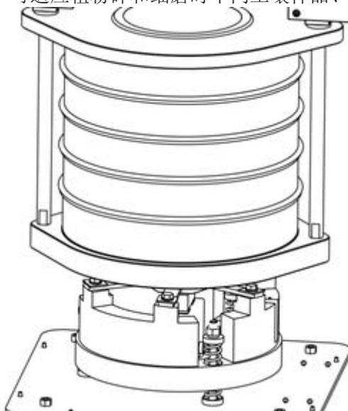
图 B.8 三维振荡筛分仪示意
