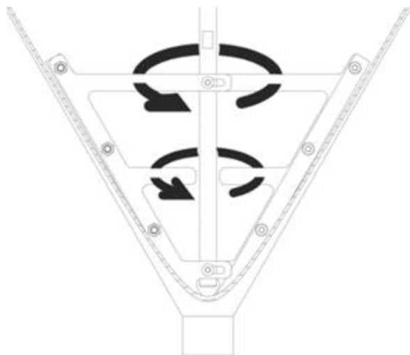
图 B.10 实时混样仪示意
