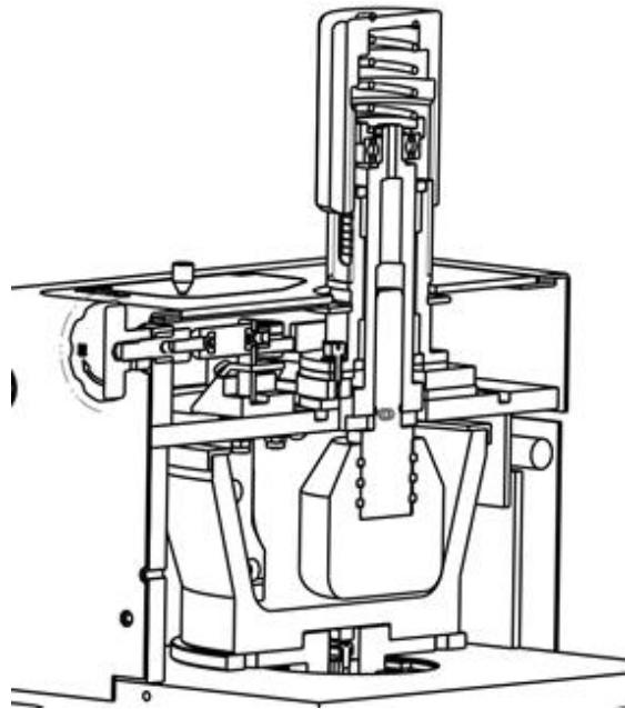
图 B. 5 臼式研磨仪示意
