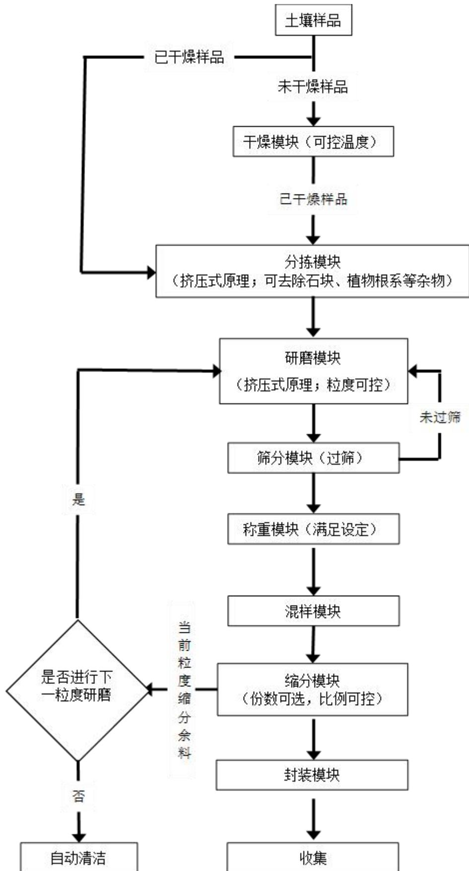
图 2 土壤样品制备自动化流程图
