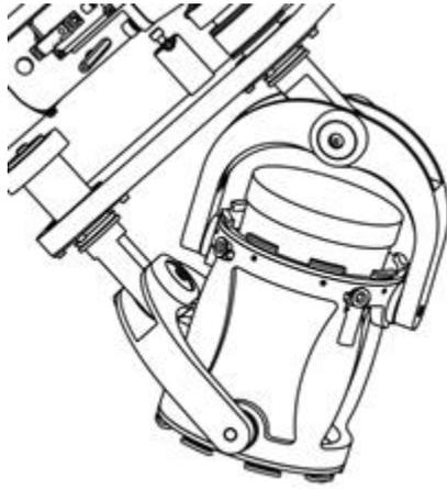
图 B.9 三维混样仪示意
