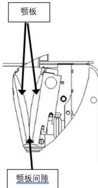
图 B. 3 颚式破碎仪示意图
